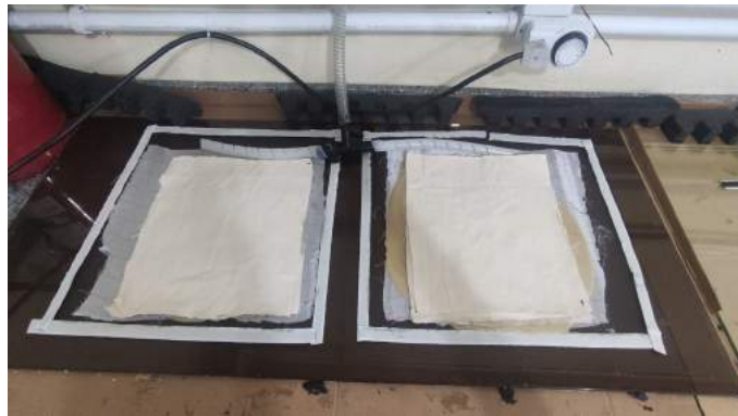
Figura 19 – Fibras Posicionadas Acima da Matriz
