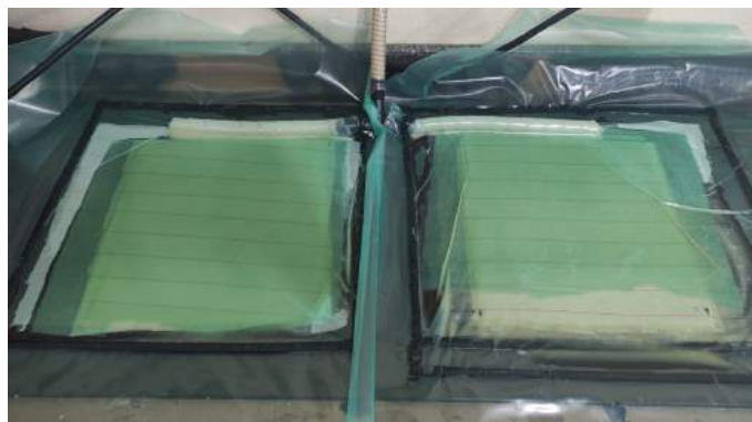
Figura 20 – Aplicação do Vácuo na Fabricação do Compósito
