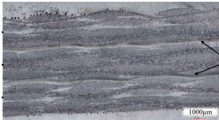
Figura 35 – Espessura das camadas.
