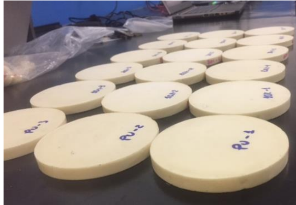
Figura 16 – Amostras com diâmetro de 100mm (a) vista superior e (b) análise da espessura
