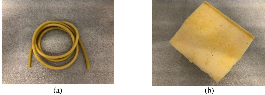
Figura 13 – Condições de contorno analisadas (a) borracha de látex e (b) espuma de baixa densidade
