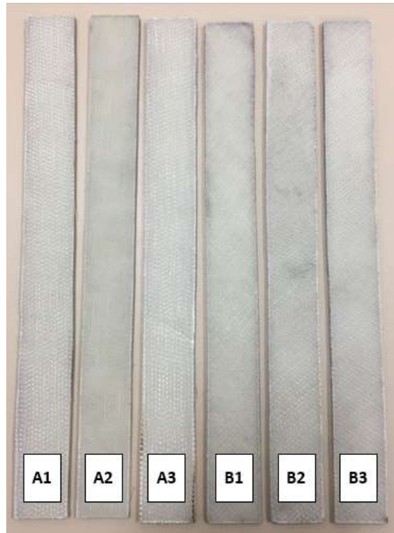
Figura 25 – Corpos de prova para ensaio de tração: A1, A2 e A3 são amostras do material com fibras a 0°/90° e B1, B2 e B3 são amostras do material com fibras a \pm 45^\circ
