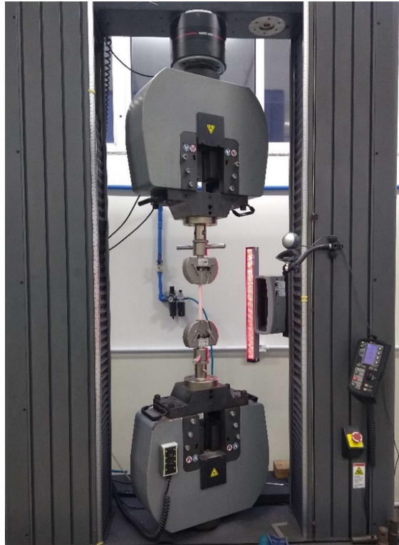
Figura 26 – Equipamento para ensaio de tração
