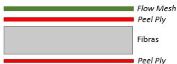
Figura 21 – Ordem de camadas para posicionar no molde
