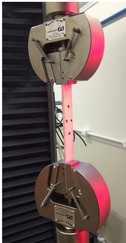
Figura 27 – Amostra tracionada no equipamento
