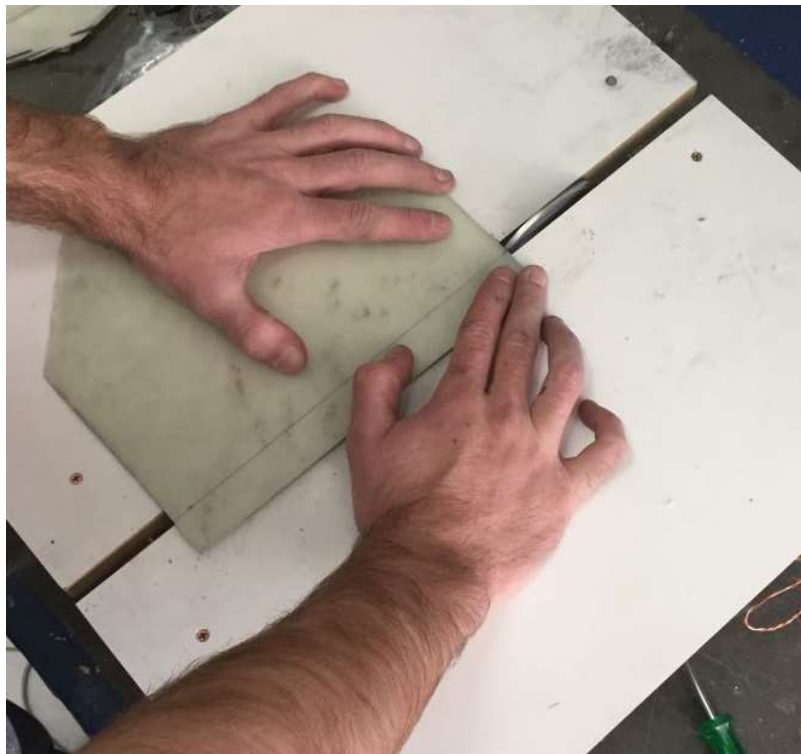
Figura 24 – Corte à disco diamantado
