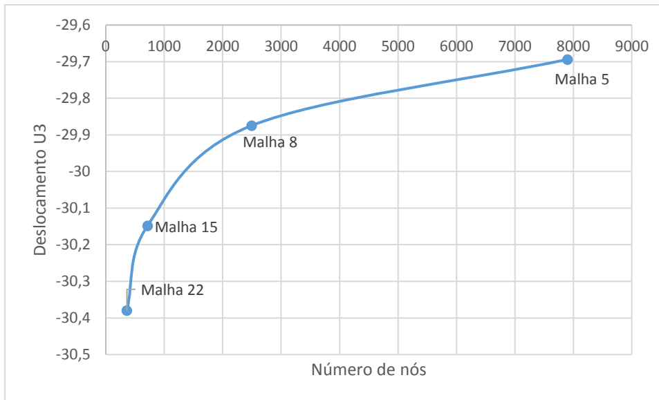
Figura 28 – Refinamento de malha para a Placa P 13
