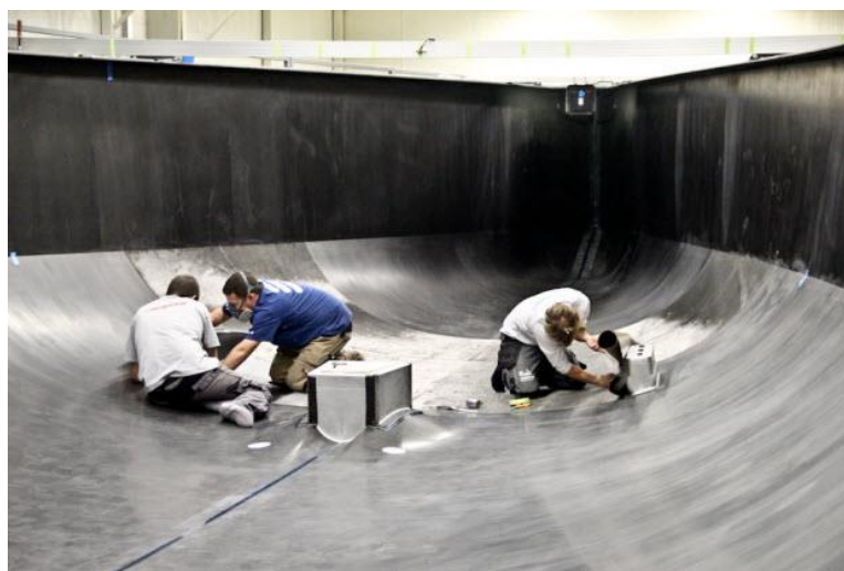
Figura 1 – Processo de laminação do Volvo Ocean 65
