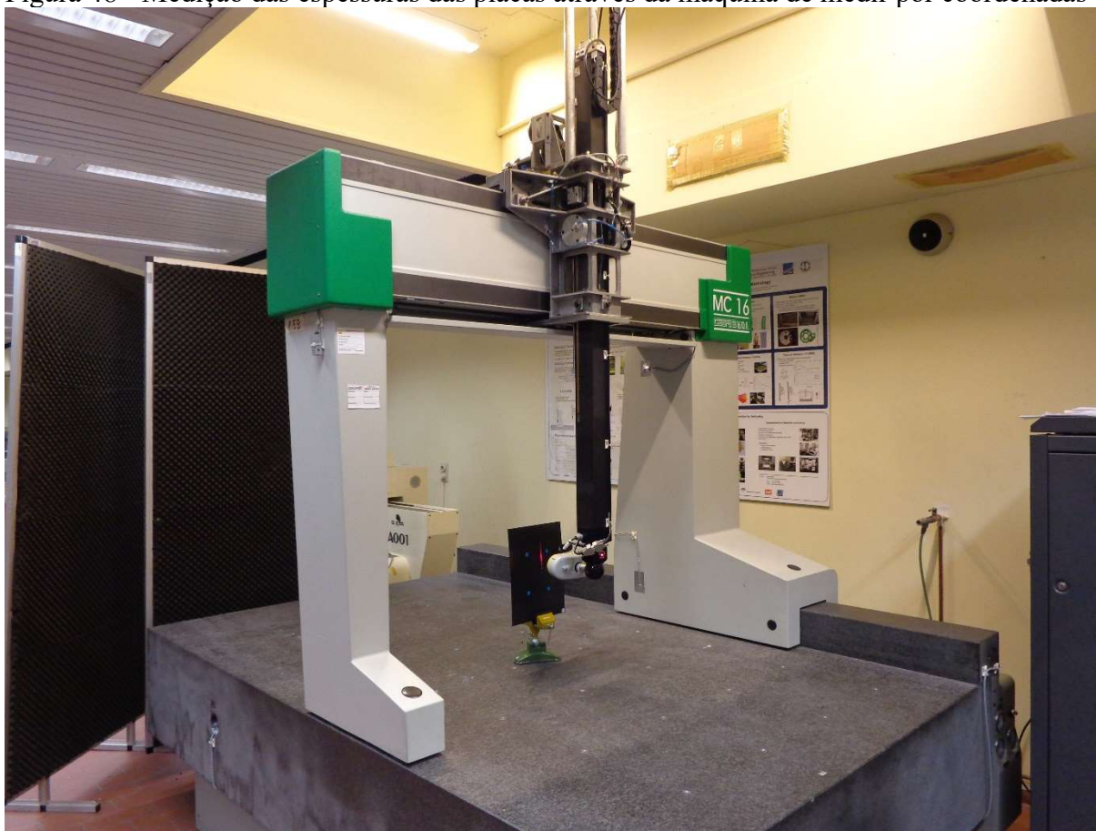
Figura 48 - Medição das espessuras das placas através da máquina de medir por coordenadas
