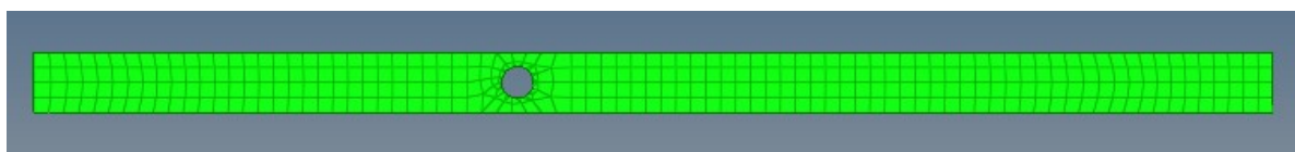
Figura 26 - Malha da estrutura danificada com um furo
