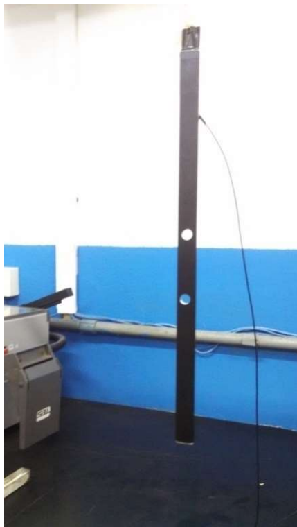
Figura 20 - Ilustração da estrutura danificada com dois furos
