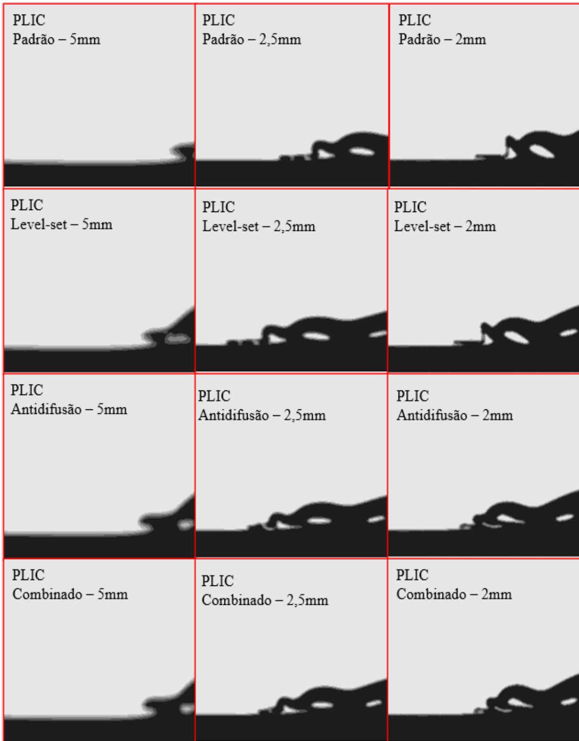
Figura 20 – Comparativo entre as malhas da resolução da interface para a função PLIC.
