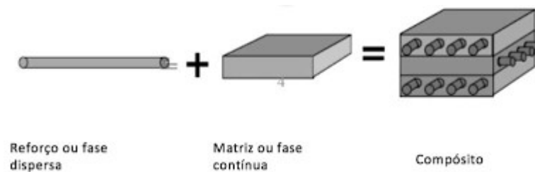
Figura 3 – Esquema da constituição básica de um compósito.
