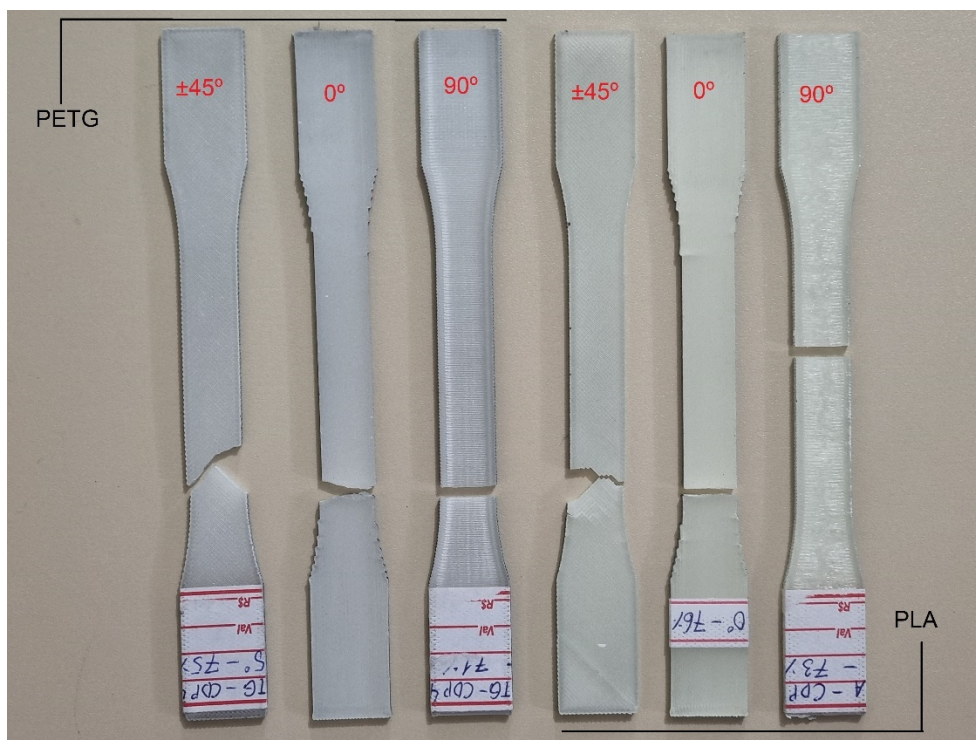
Figura 28 – Falhas características de cada condição para o PLA e PETG.
