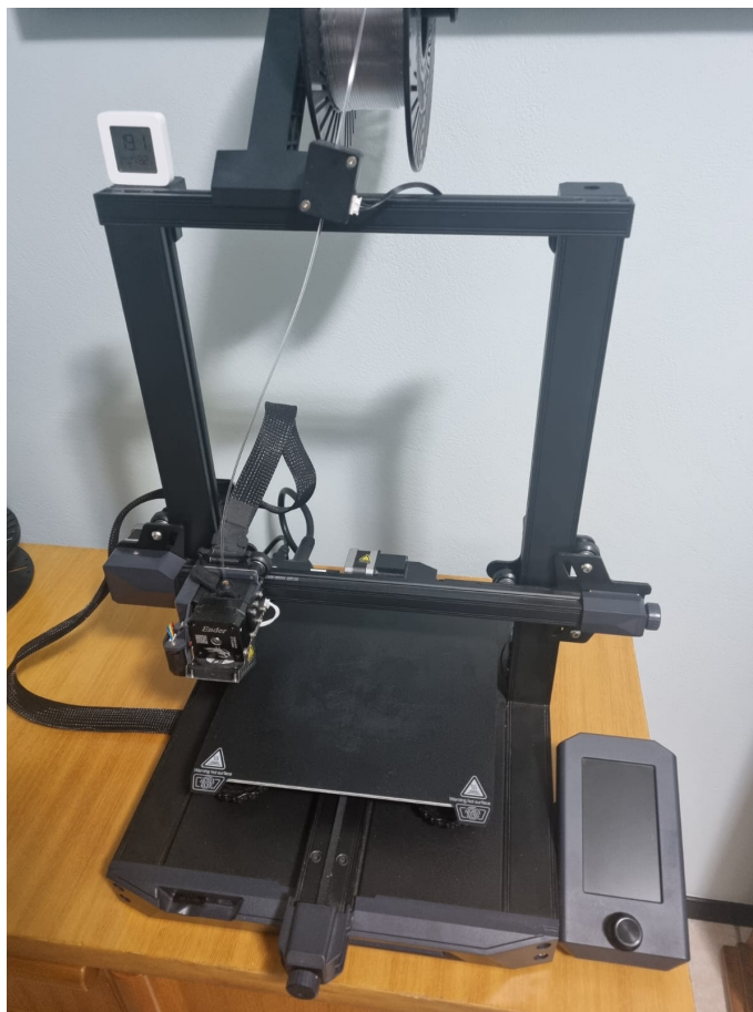
Figura 12 – Impressora utilizada para a impressão dos corpos de prova.
