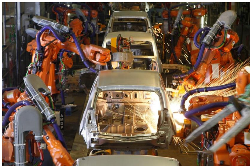
Figura 2.3 – Linha de produção de chassi monobloco.
