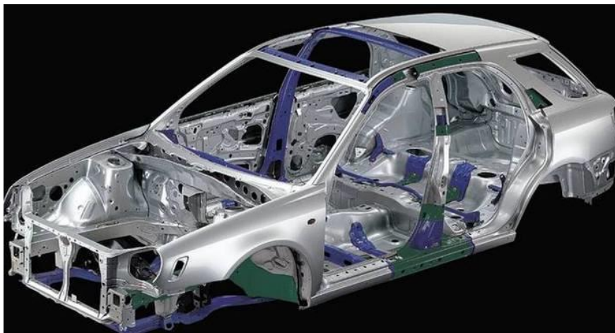
Figura 2.2 – Estrutura de um chassi monobloco.
