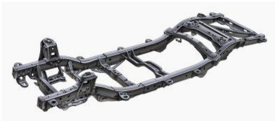
Figura 2.1 – Exemplo chassi tipo escada.
