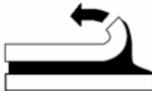
Figura 11 – Arrancamento em junta adesiva.
