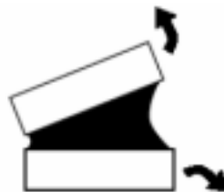
Figura 10 – Clivagem em junta adesiva.
