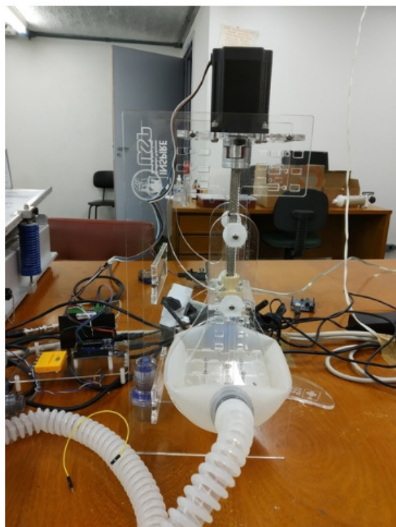
Figura 1 - Inspire - Ventilador Pulmonar Emergencial desenvolvido na USP
