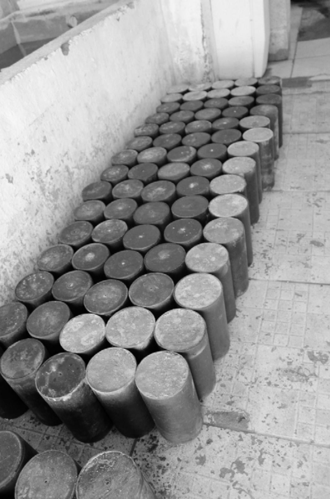
*deu tudo certo? Molda os corpos de prova. Nós moldamos quatro corpos de prova e a gente rompe dois com 7 e dois com 28 dias.*
