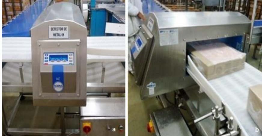
Figura 14 - Detector de metal de produtos congelados.
