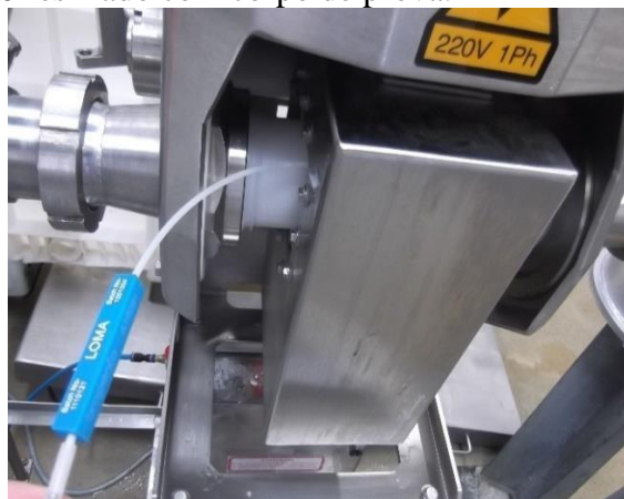
Figura 16 - Detector de CMS resfriado com corpo de prova.
