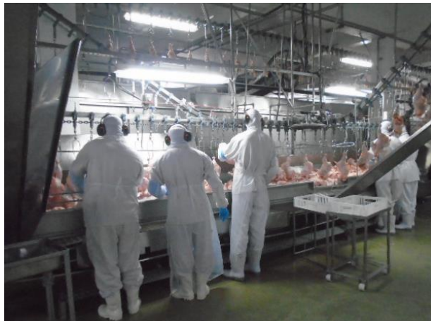
Figura 12 - Rependura aves na saída do chiller .
