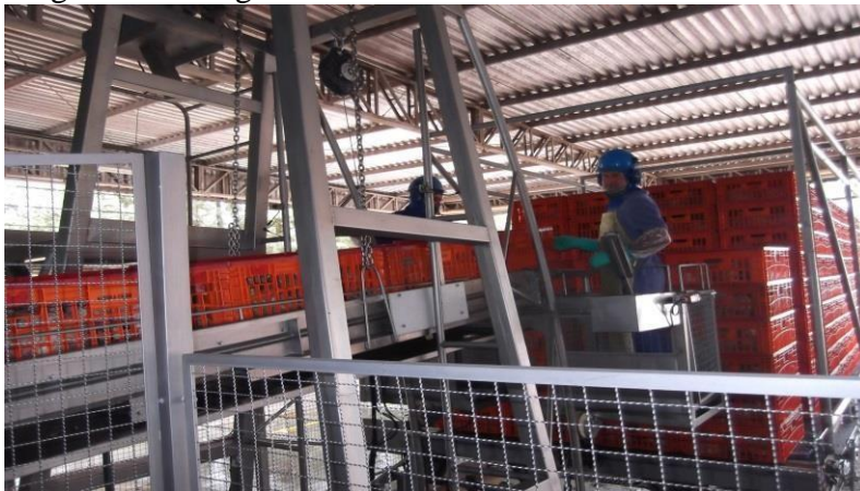
Figura 4 - Descarregamento das gaiolas do caminhão com o auxílio de elevador mecânico.
