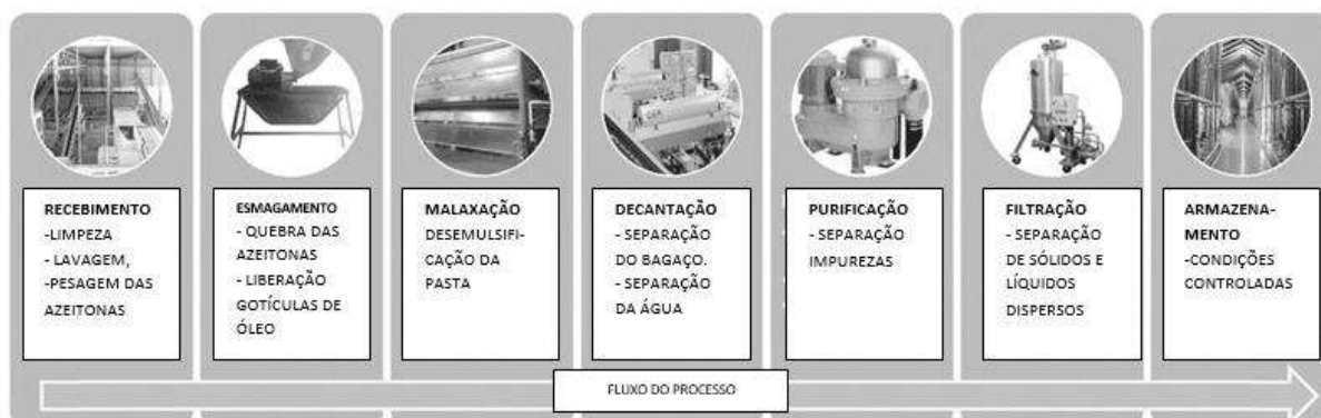
Figura 1 - Fases do processo de produção do azeite de oliva.
