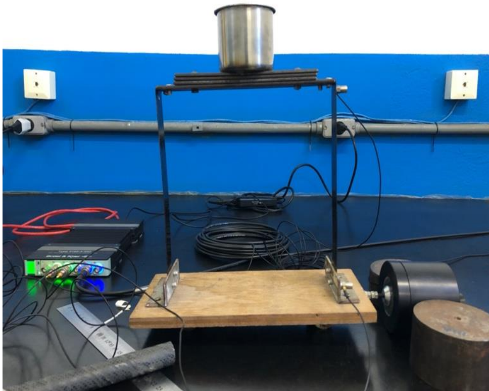
Figura 3.6 – Absorvedor dinâmico de vibração, sujeito a aplicação de uma força em sua massa e base.
