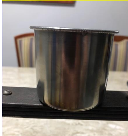
Figura 3.3 – Caneca soldada no topo da estrutura.
