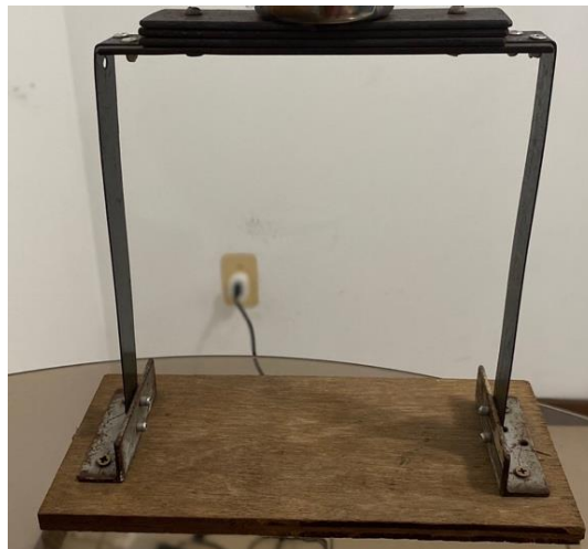
Figura 3.4 – Estrutura de pórtico sem caneca.
