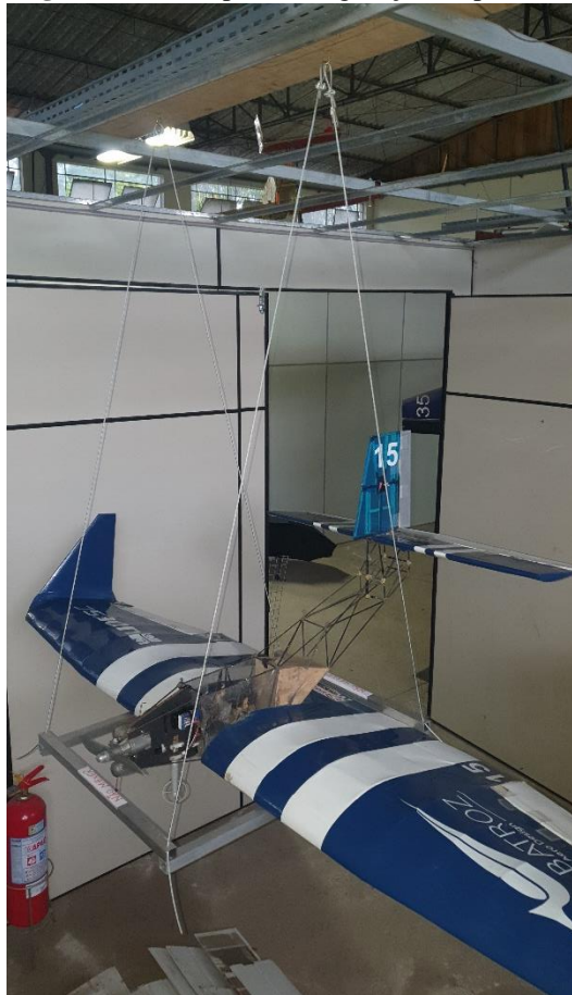
Figura 3.5 – Setup de configuração do pêndulo.
