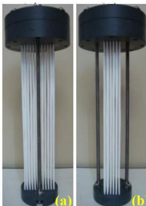
Figura 7 - Imagens frontal (a) e lateral (b) do módulo de membranas.
