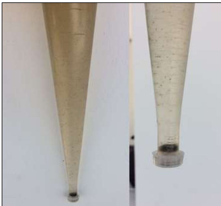
Figura 10: Análise de sedimentabilidade do compartimento aerado
