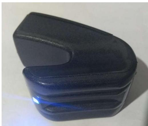
Figura 16 - Arco eletrônico *E-Bow*. Fonte: O autor.
