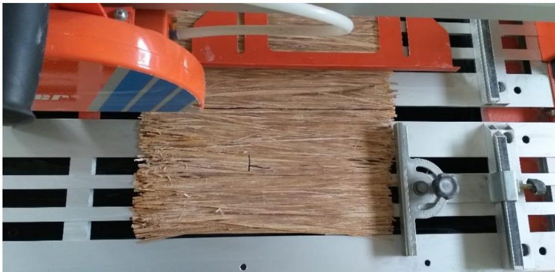
Figura 3.13 – Processo de corte da placa de compósito nos corpos de provas.
