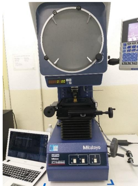
Figura 3.8 – Projetor de perfil PL-A3000 da Mitutoyo, equipamento do laboratório de Metrologia da UDESC.
