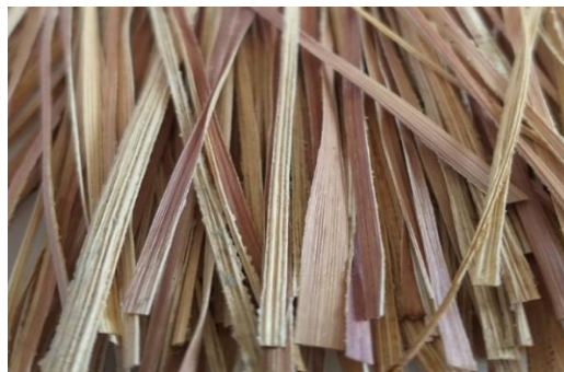
Figura 3.3 – Fita de fibra de bananeira pronta após finalizar os processos de fabricação.
