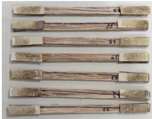
Figura 3.14 – Corpos de provas da amostra FST finalizados para o ensaio de tração.
