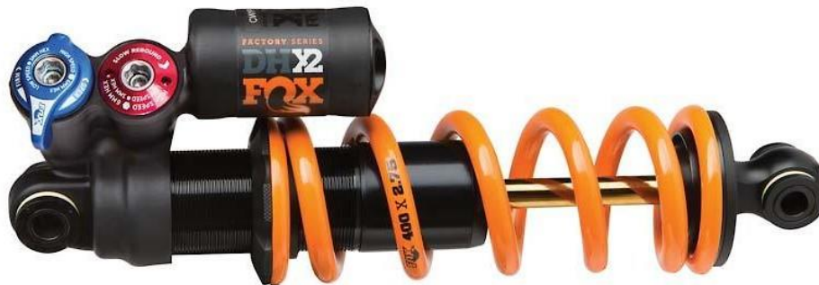
Figura 17 – Modelo de coilover da fabricante FOX utilizado nas simulações.
