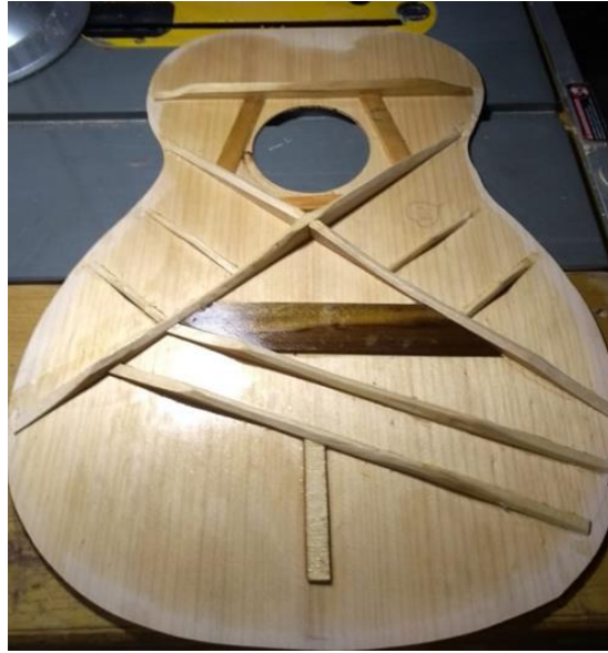
Figura 3.9 – Conjunto do tampo após colagem e aplicação do óleo
