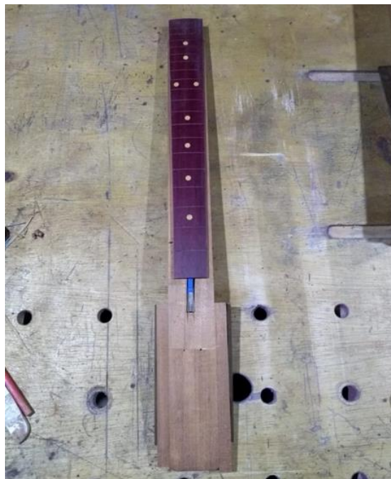
Figura 3.15 – Braço com tensor e escala
