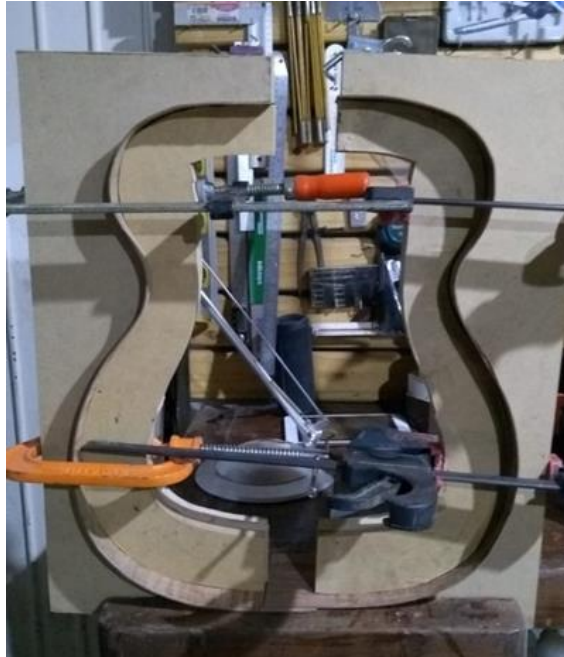
Figura 3.5 – Lâminas das laterais pressionadas sobre o molde
