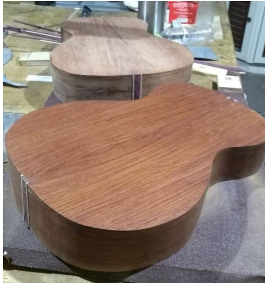
Figura 3.11 – Fundo incorporado às laterais e adorno
