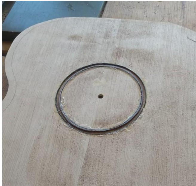
Figura 3.8 – Adorno em volta da boca do instrumento
