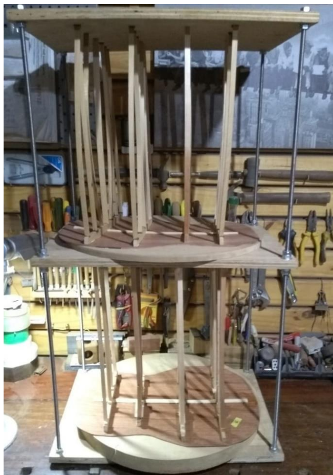
Figura 3.7 – Colagem das estruturas ao fundo na estante de colagem sobre os discos abaulados
