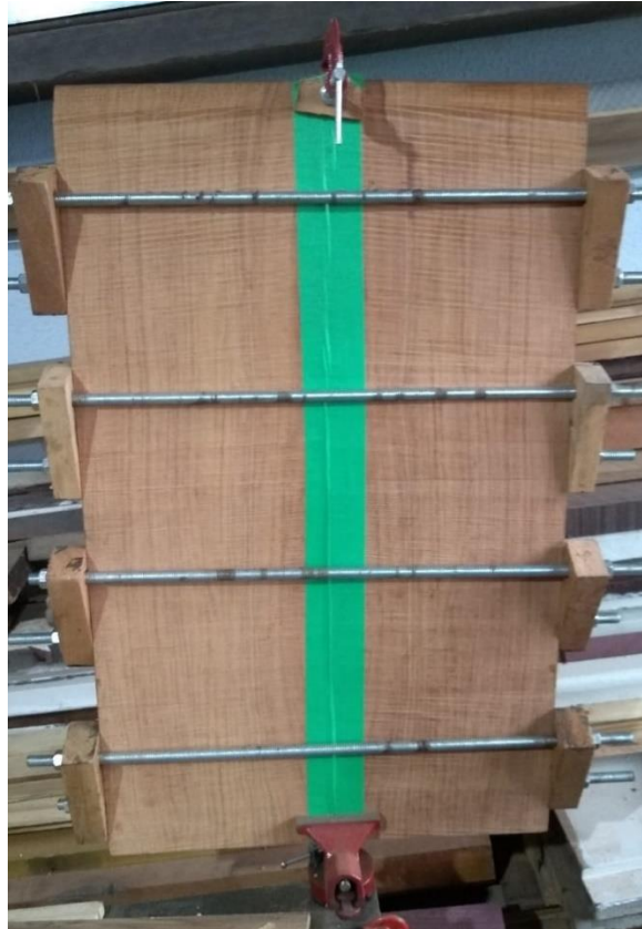
Figura 3.3 – Fixação e colagem das lâminas do fundo do violão
