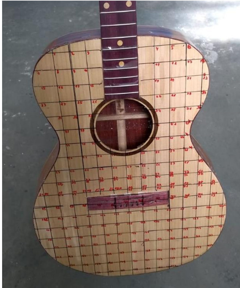
Figura 3.22 – Marcação dos pontos de medição no violão
