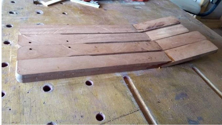
Figura 3.14 – Resultado do corte e colagem em ângulo
