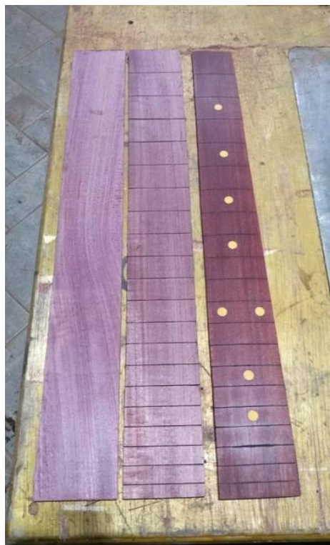
Figura 3.13 – Escala em três etapas de sua confecção
