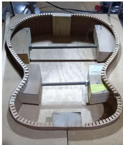
Figura 3.10 – Rebaixo para assentamento das estruturas e pressionamento das laterais sobre o molde
