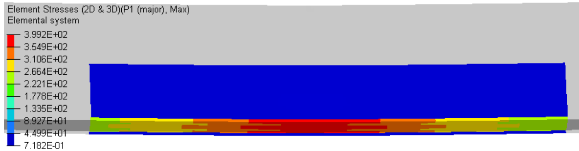
Figura 58 – Simulação Numérica do Ensaio de Flexão - Tensão na Direção X
