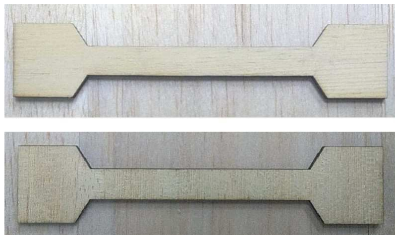
Figura 32 – CP com as Fibras Externas à 0^\circ em (1) e à 90^\circ em (2).
