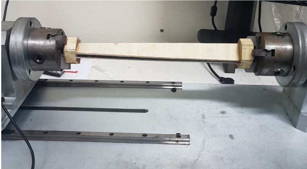
Figura 51 – Ensaio de Torção da Viga Caixaão
