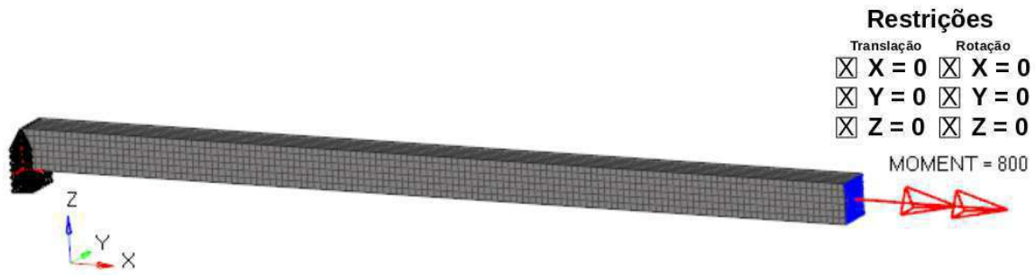
Figura 28 – Modelo em Elementos Finitos do Ensaio de Torção
