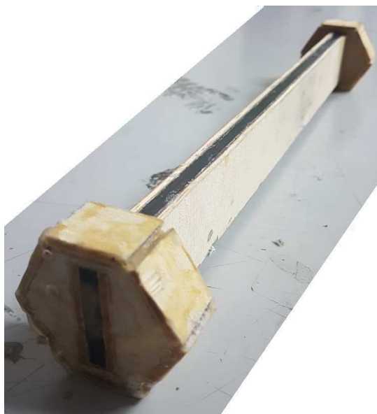
Figura 52 – CP para Ensaio de Torção da Viga Caixaão
