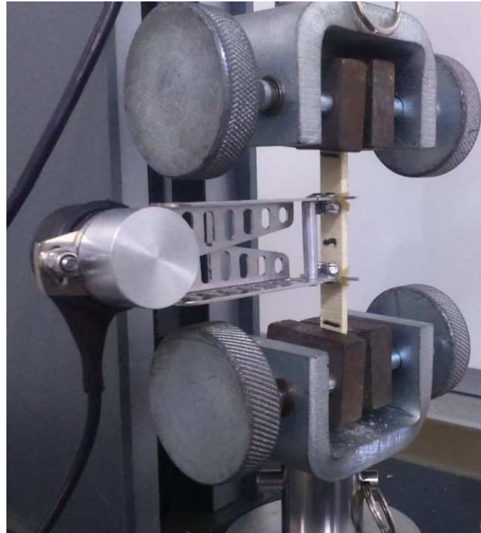
Figura 31 – Ensaio do Compensado em Tração
