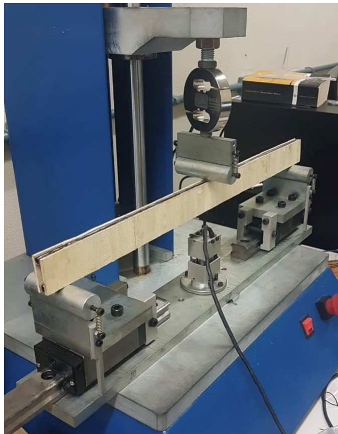
Figura 49 – Ensaio de Flexão da Viga Caixão
