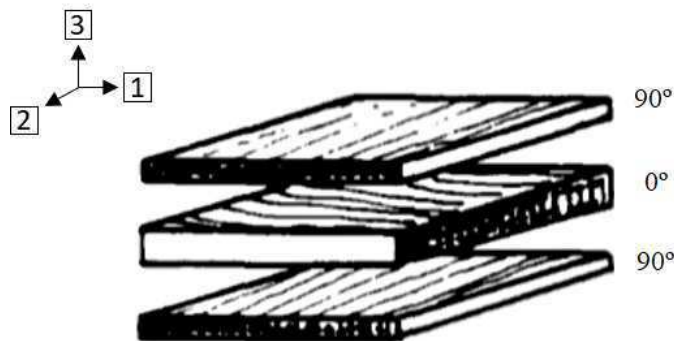
Figura 30 – Distribuição das lâminas do compensado
