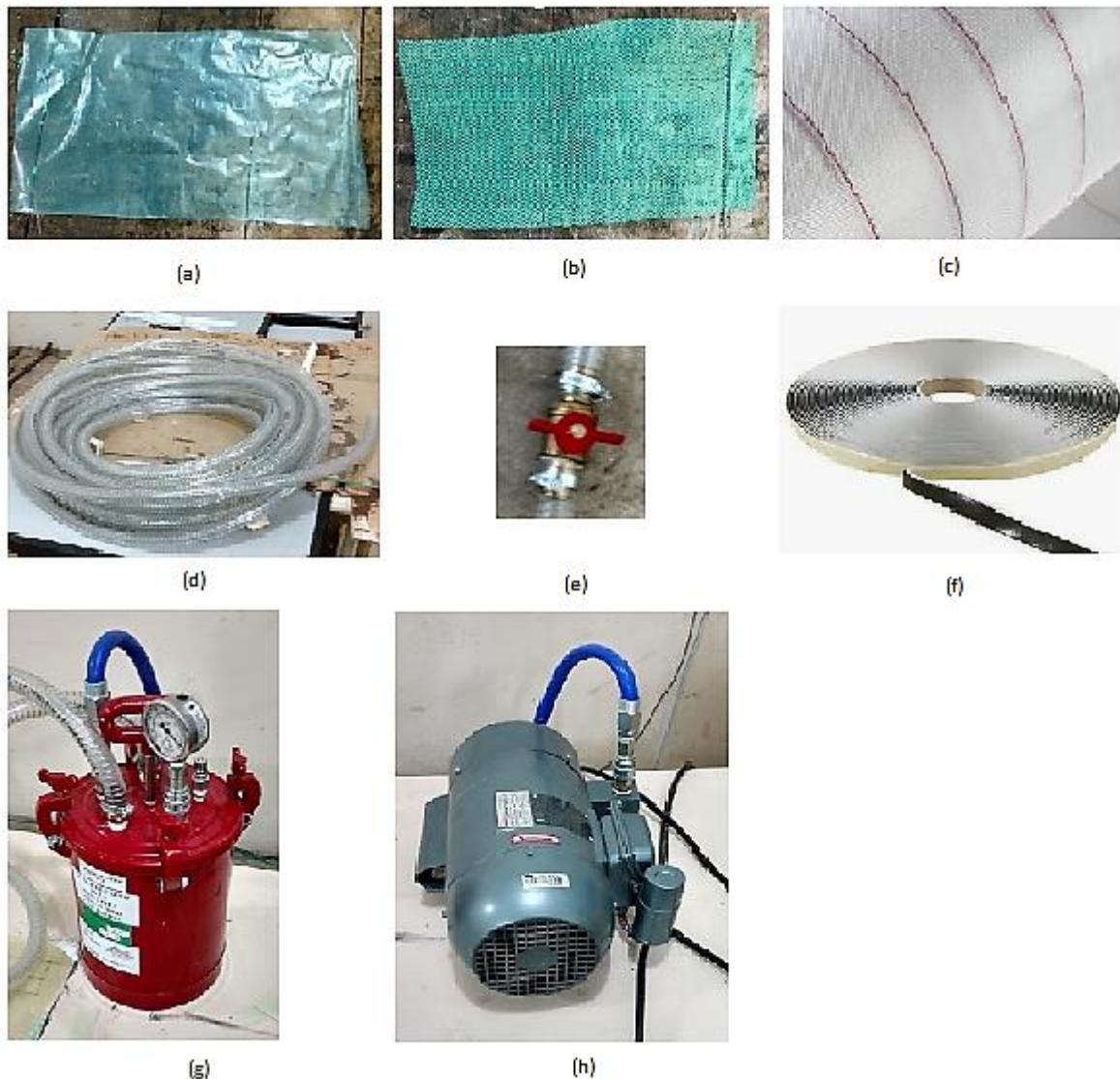
Figura 3.2 – Componentes utilizados no processo: (a) Plástico de vedação, (b) Flow Mesh , (c) Peel Ply , (d) Mangueiras, (e) Válvula, (f) Fita de vedação, (g) Gerador de vácuo e (h) Bomba.
