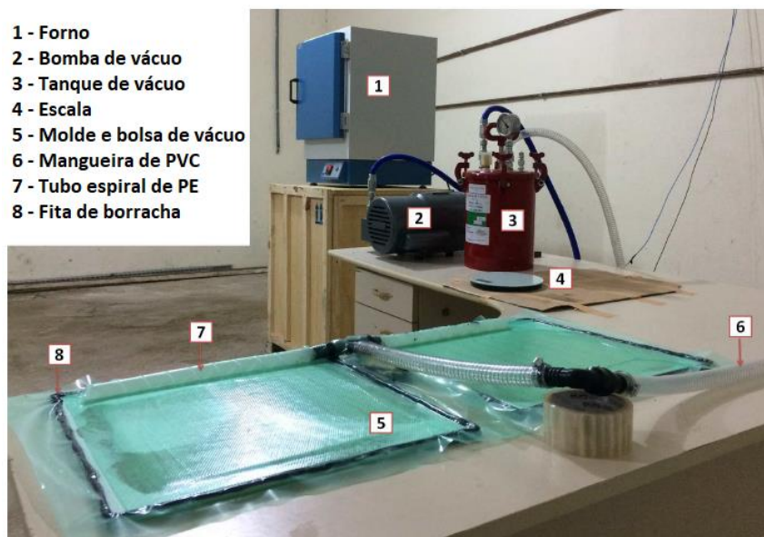
Figura 3.1 – Layout do processo de fabricação VARTM
