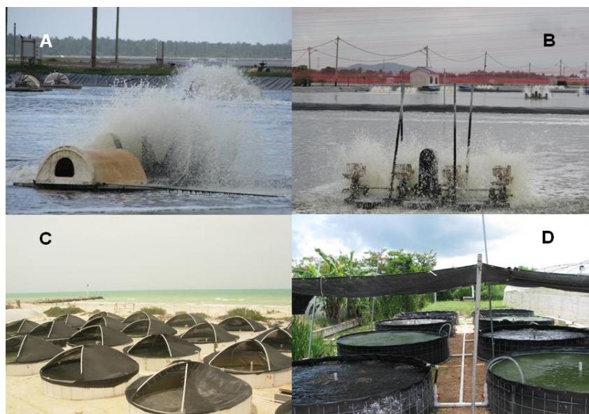
Sistema de bioflocos em escala comercial em Bali (A) Malásia (B) e em baixa escala no México (C e D).
