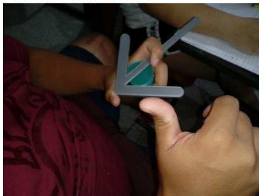
b) Equipe G1 utilizando o instrumento para marcar o centro do cilindro
