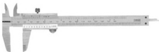
Figura 1.1: Paquímetro. Instrumento de medição.
