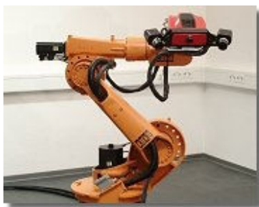
Figura 7 - Modelo de câmeras filmadoras para reconstrução em 3D. Fonte: GOM (2006).
