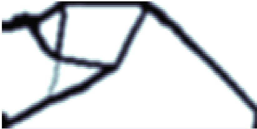
Figura 20 – Topologia obtida com restrição de volume de 15% - caso 3
