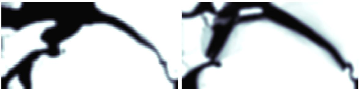
Figura 45 – Influência do refino da malha: 9600 elementos (esquerda) e 38400 elementos (direita).  $q = 2$
