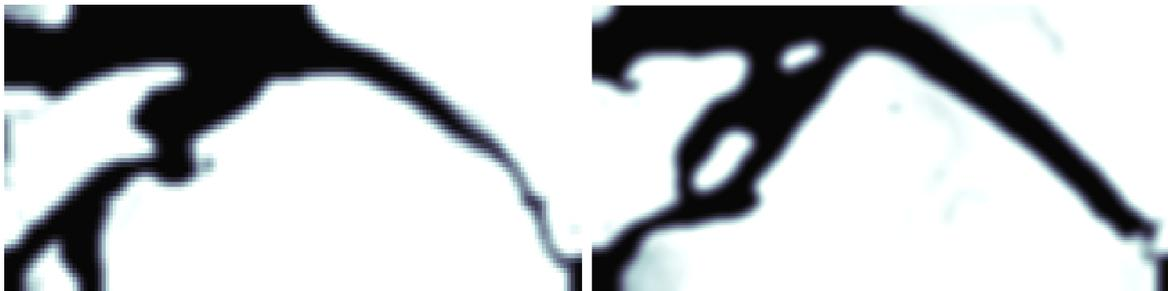
Figura 47 – Influência do refino da malha: 9600 elementos (esquerda) e 38400 elementos (direita).  $q = 1,5$ .
