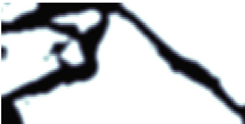
Figura 19 – Topologia obtida com restrição de volume de 25% - caso 2
