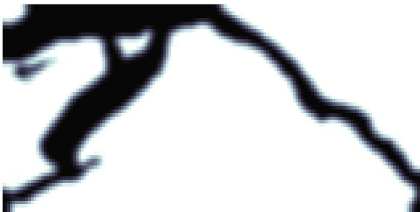
Figura 18 – Topologia obtida com restrição de volume de 40% - caso 1
