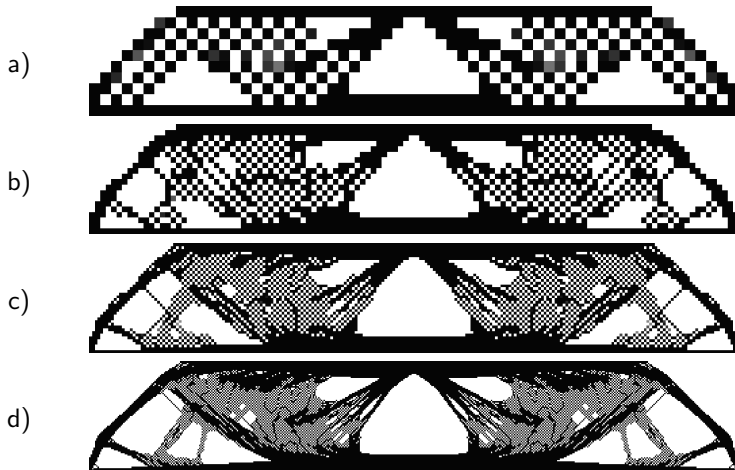
Figura 6 – Instabilidade de tabuleiro no problema de minimização de flexibilidade da Figura 4. Solução para uma discretização de: a) 300; b) 1200; c) 4800; e d) 19200 elementos.
