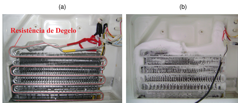
Figura 4.3: (a) Detalhe do Evaporador Montado com uma Resistência de Degelo; (b) Condição do Evaporador com Formação de Gelo
