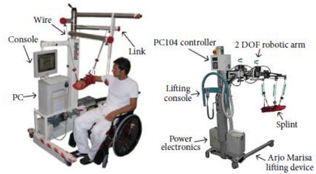
Figura 7 - Manipulador paralelo guiado por cabos para a reabilitação humana
