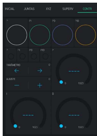
Figura 32 – Aba de controle PID da interface
