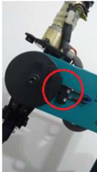
Figura 41 – Elemento auxiliar para o referenciamento
