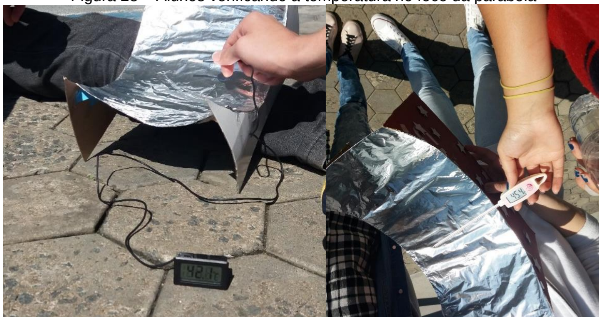
Figura 28 – Alunos verificando a temperatura no foco da parábola
