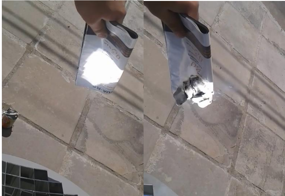
Figura 25 – Papel incendiado pelos raios concentrados no foco do refletor
