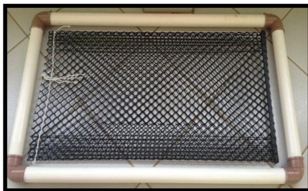
Figura 7 – Mini balsas flutuantes utilizadas para exposição das ostras do mangue, Crassostrea gasar , no Sistema Estuarino de Laguna, SC
