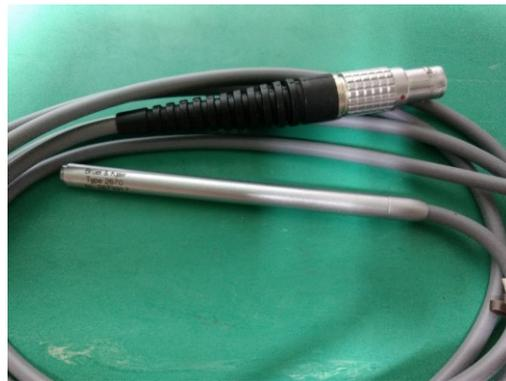
**Figura 17: Pré-Amplificador B&K Type 2670**
