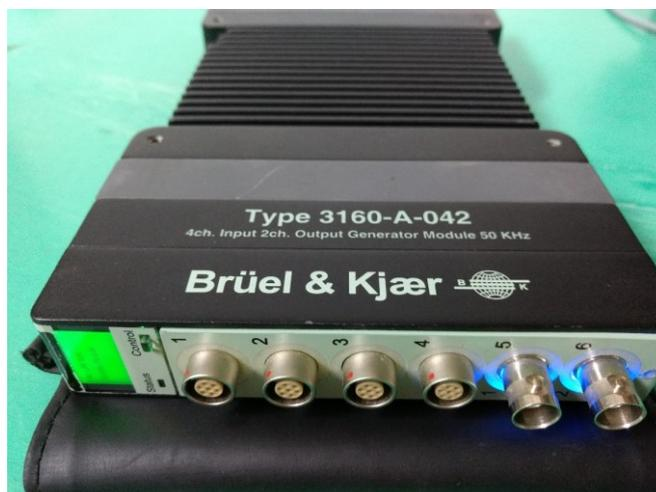
**Figura 18: Módulo de Aquisição B&K Type 3160-A-042**
