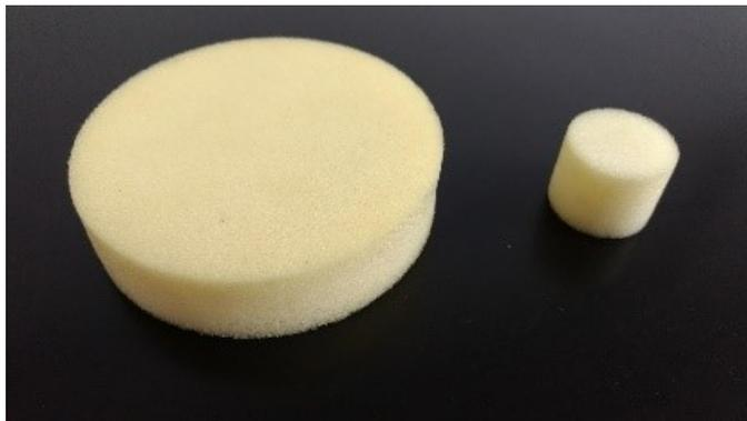
**Figura 14: Amostra Padrão de Calibração Bruel & Kjaer**
