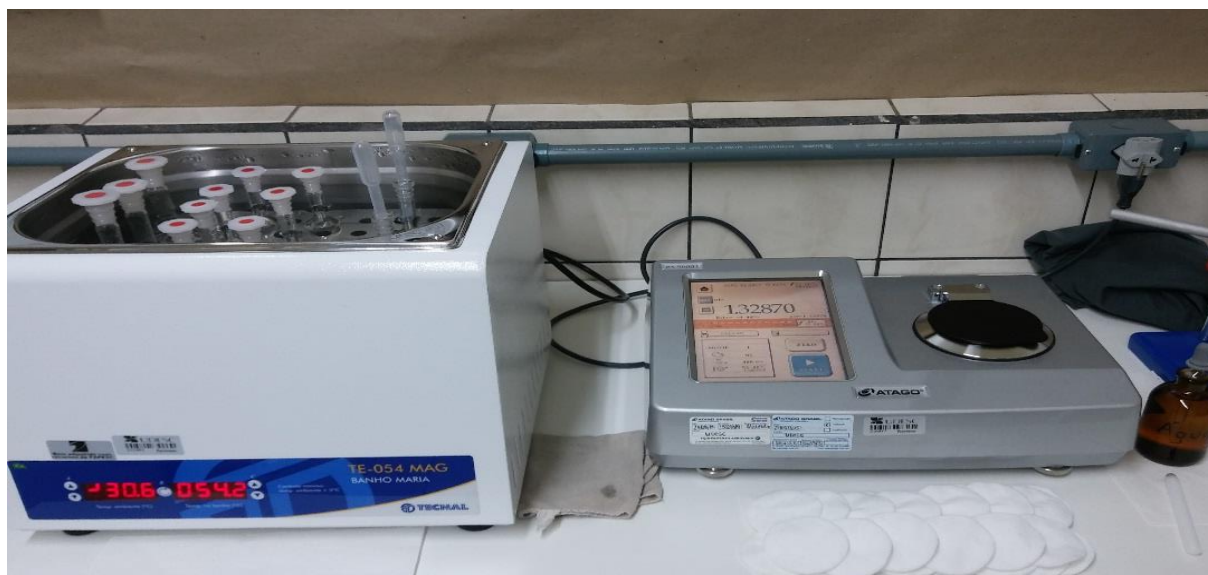
Figura 5 - Balões volumétricos acondicionados em banho termostático anteriormente a leitura refratométrica
