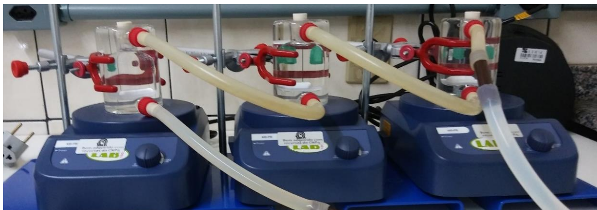
Figura 2 - Células de vidro encamisado de 63 mL
