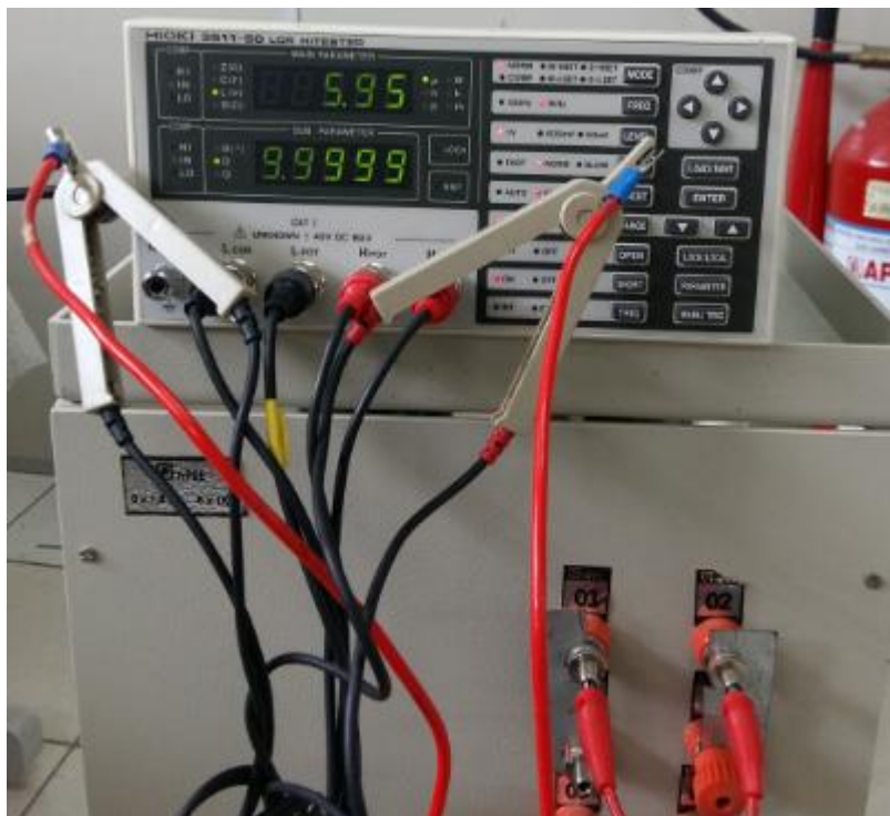
Figura 48 - Medições na carga com a ponte RLC.
