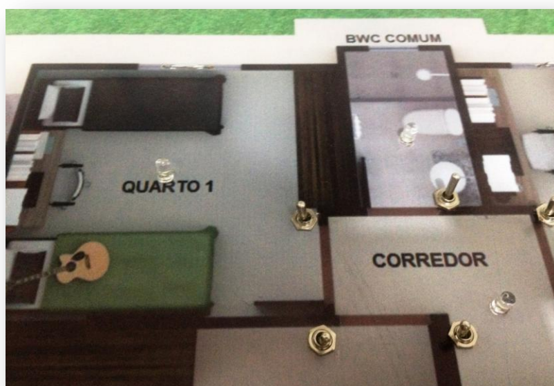
Figura 50 - Detalhe dos leds, interruptores e sensores
