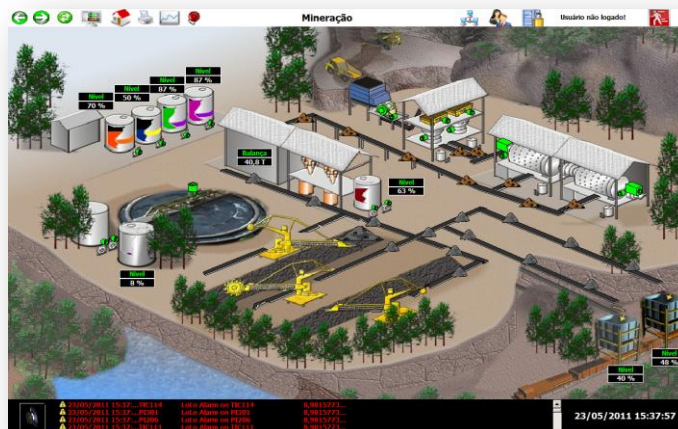
Figura 15 - Interface do supervisor de uma estação de mineração
