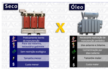
Figura 4.12 – Comparativo entre os transformadores
