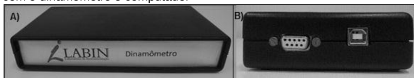
Figura 6 - Sistema de aquisição de dados. A) Estrutura externa do sistema de aquisição e B) Entrada e saída dos cabos para a conexão com o dinamômetro e computador
