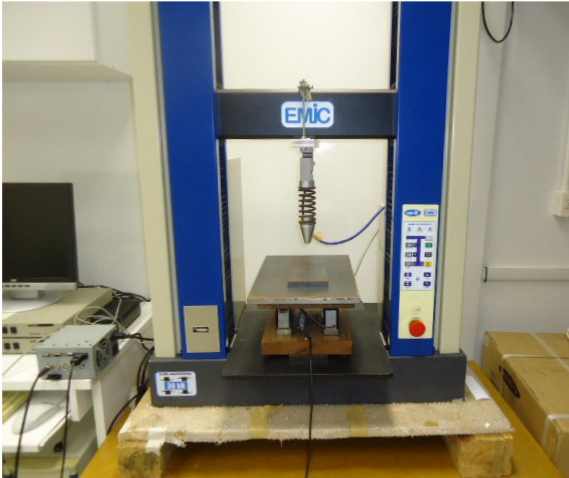
Figura 14 – Máquina de ensaios EMIC modelo DL 3000
