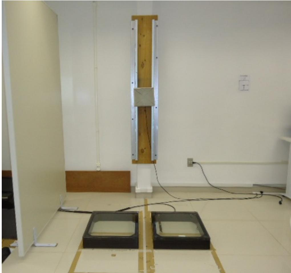
Figura 10 - Plataformas de força AMTI e alvo fixo instrumentado
