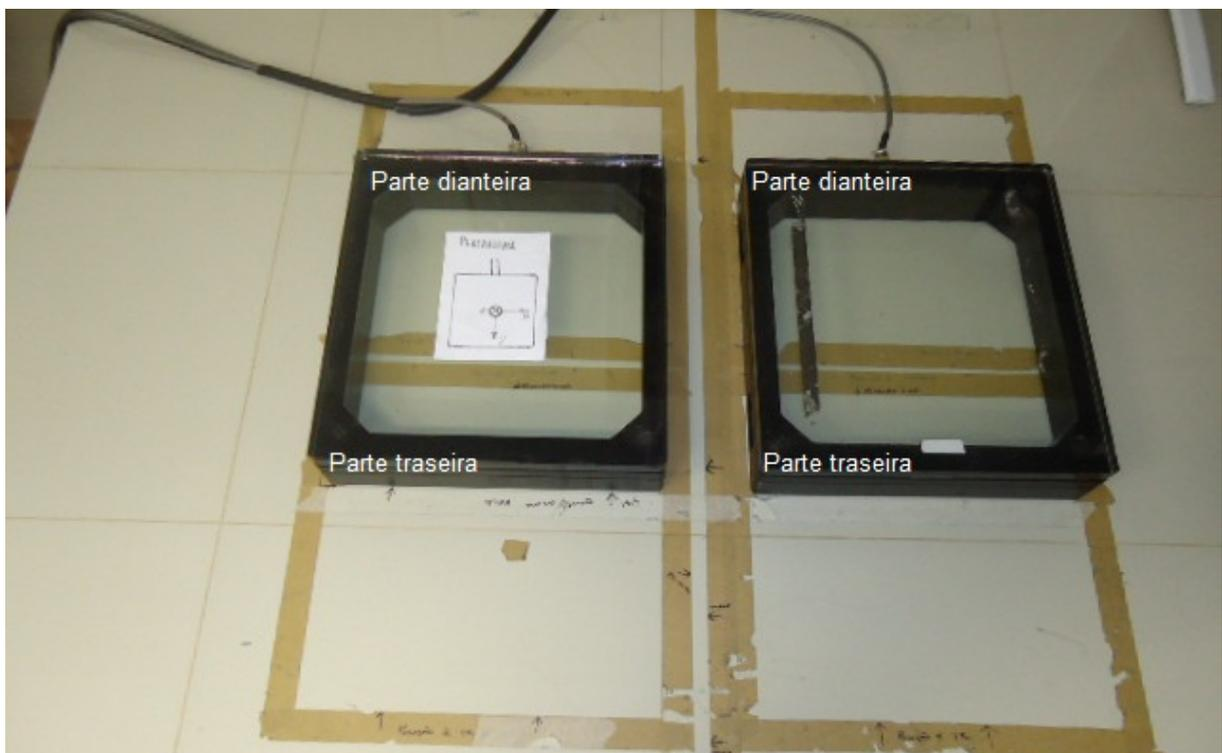
Figura 13 – Plataformas de força com as medidas referenciadas para postura natural
