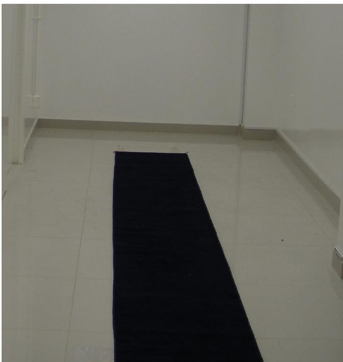
**A - Tapete acarpetado de teste com 65,5 cm de largura e 390 cm de comprimento**
