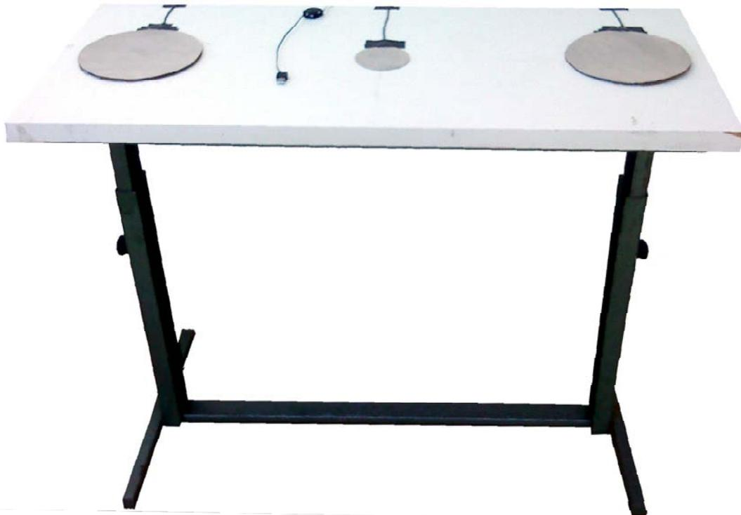
Vista frontal onde é possível visualizar: os ajustes de altura, cabo conector usb retrátil, placas sensíveis ao toque
