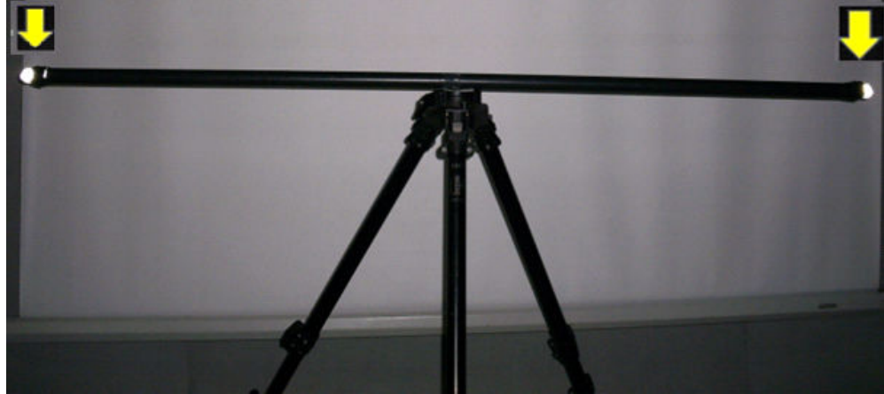
Figura - 6 Calibrador bidimensional com marcadores reflexivos.
