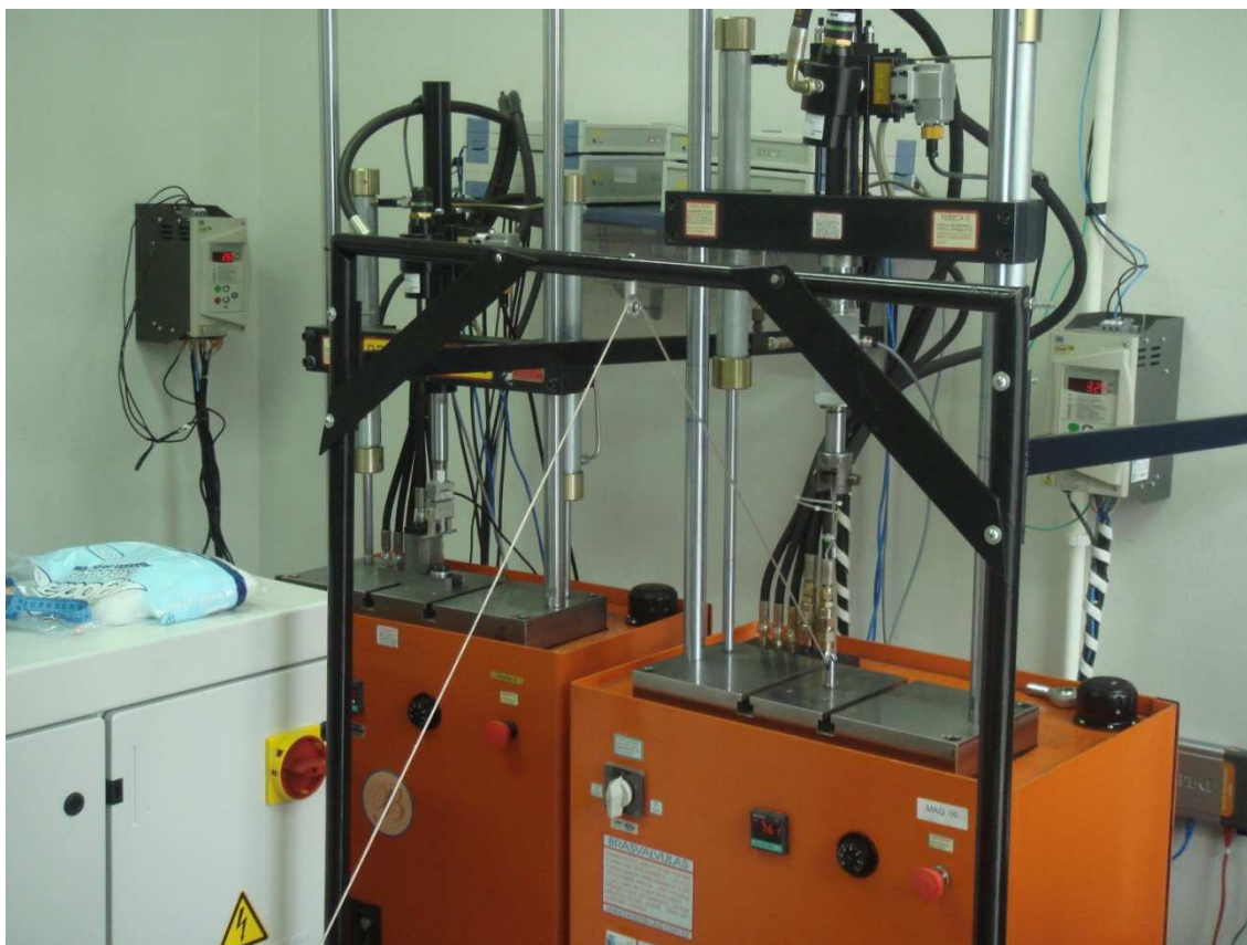
Figura 5. Máquina de ensaio dinâmico de tração e compressão Brasvalvulas BME 05 40 180 120/AT MNB®.
